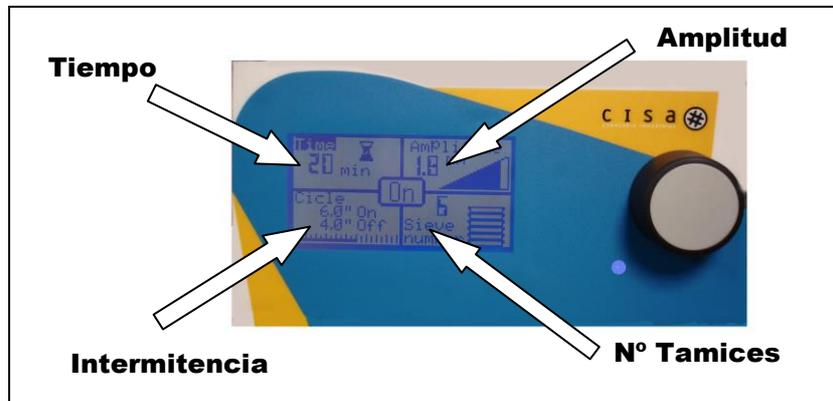
Ajuste de parámetros con sistema monomando y pantalla LCD que permite tener acceso a toda la información durante el tamizado.
